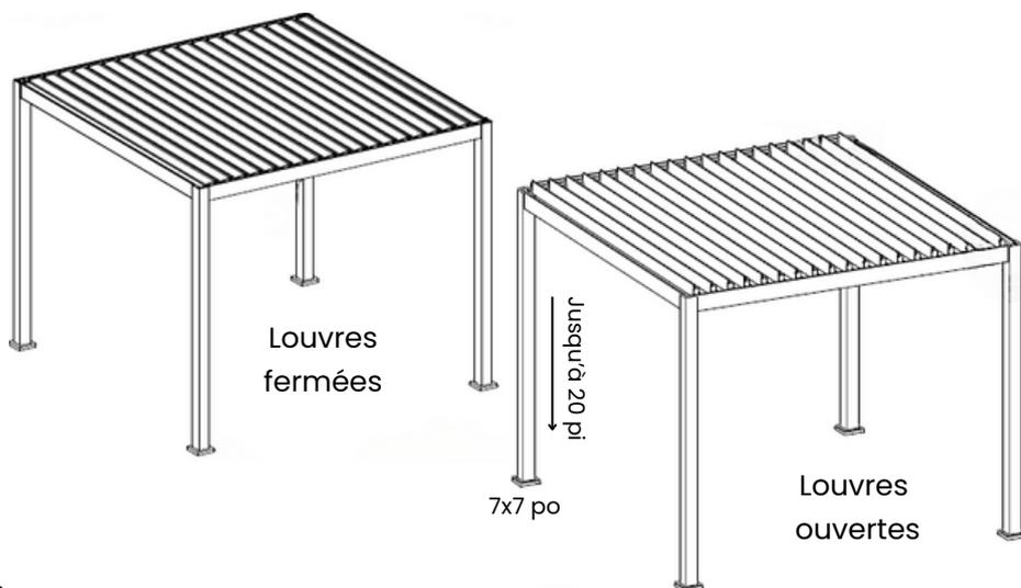
Un espace minimum de 12 pouces est nécessaire entre le bas de la poutre et le haut des louveres pour l'installation.
